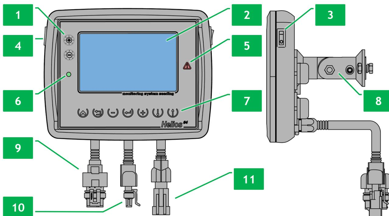
**Рисунок 1** Панель оператора
