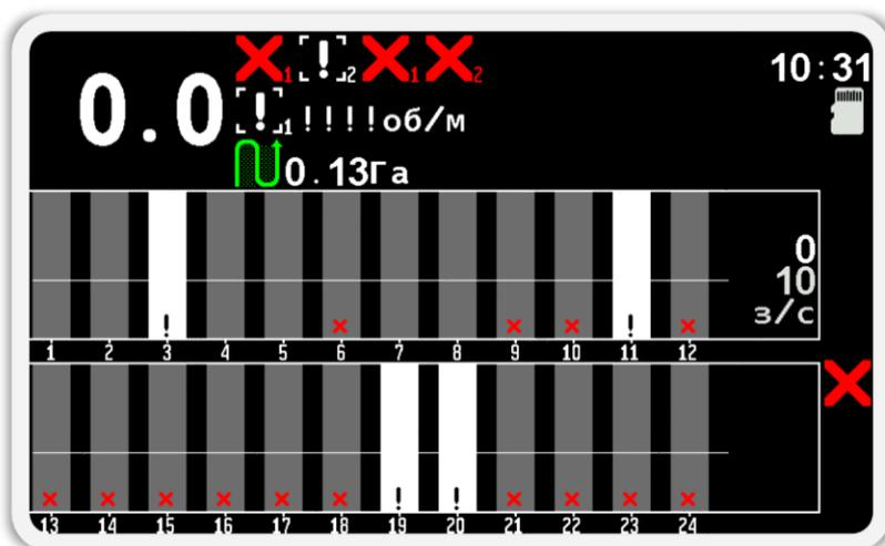
**Рисунок 24** Пример отображения «Главного экрана» тогда, когда нет связи с некоторыми датчиками, а также некоторые датчики сняты с контроля.
