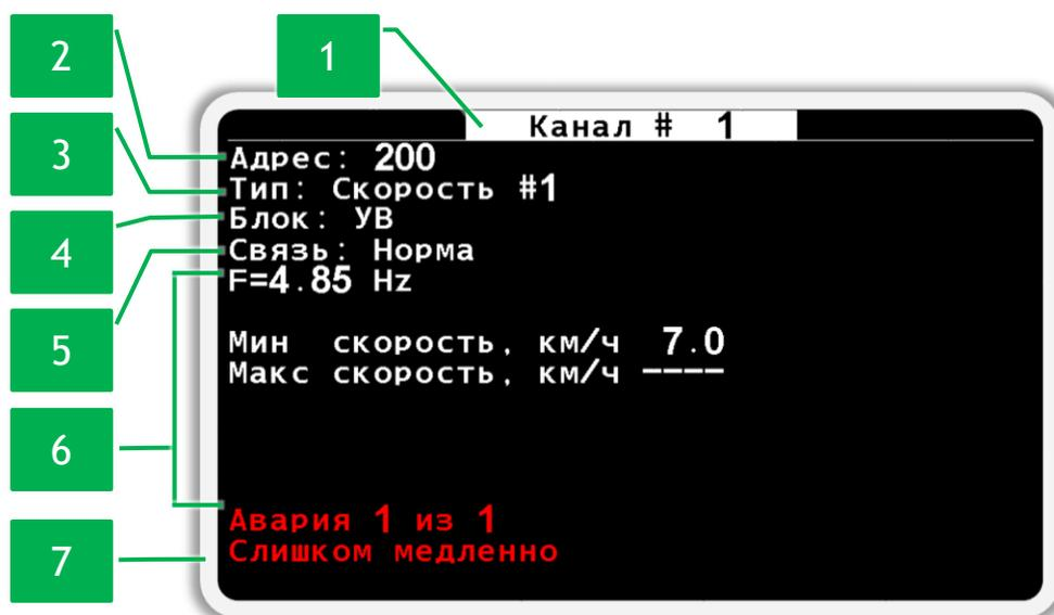
Рисунок 34 Пример экрана просмотра состояния датчика скорости
