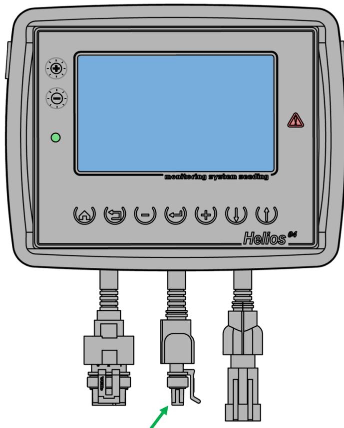
**Рисунок 57** Кабельный ввод жгута связи RS-485
