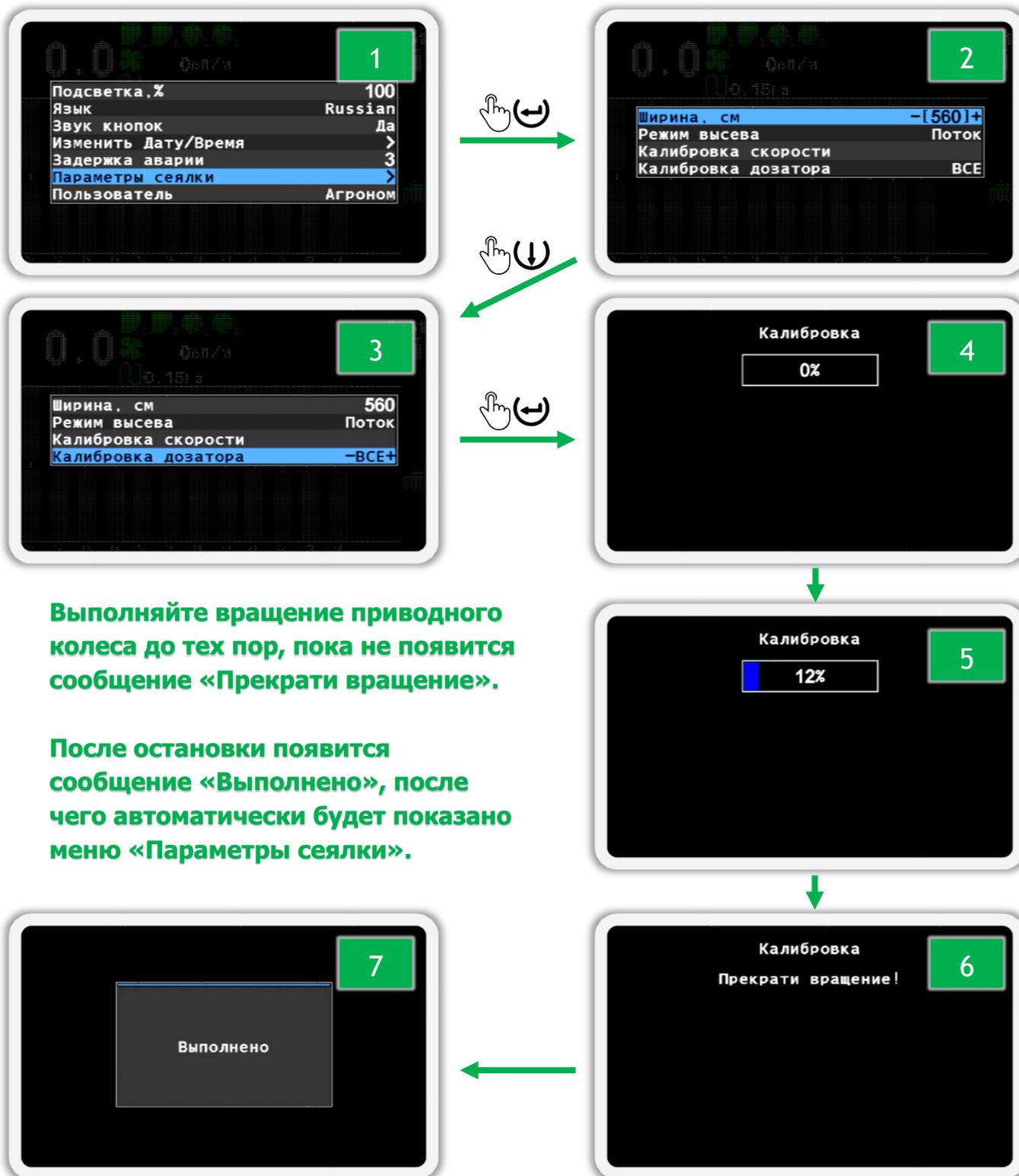
Рисунок 37 Калибровка дозатора
