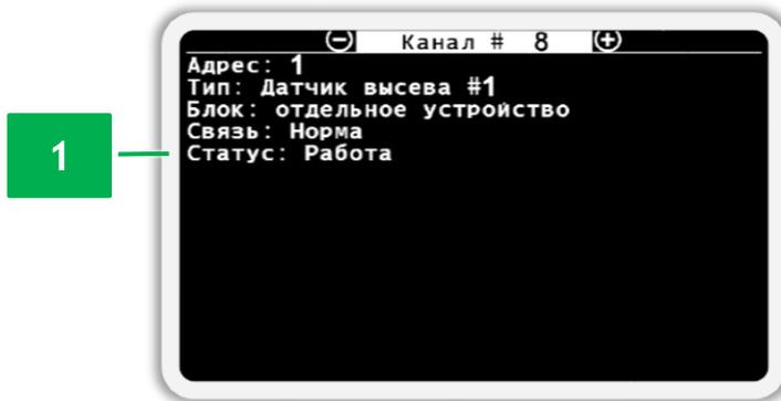
**Рисунок 45** Экран просмотра состояния датчика контроля высева
