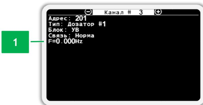
Рисунок 36 Экран просмотра состояния датчика вращения вала дозатора
