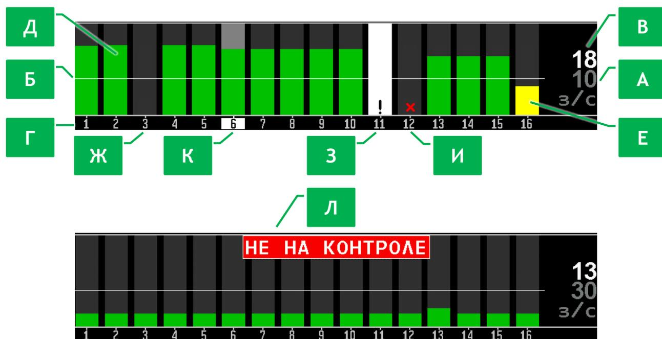
**Рисунок 12** Диаграмма контроля высева в режиме контроля «Поток»
