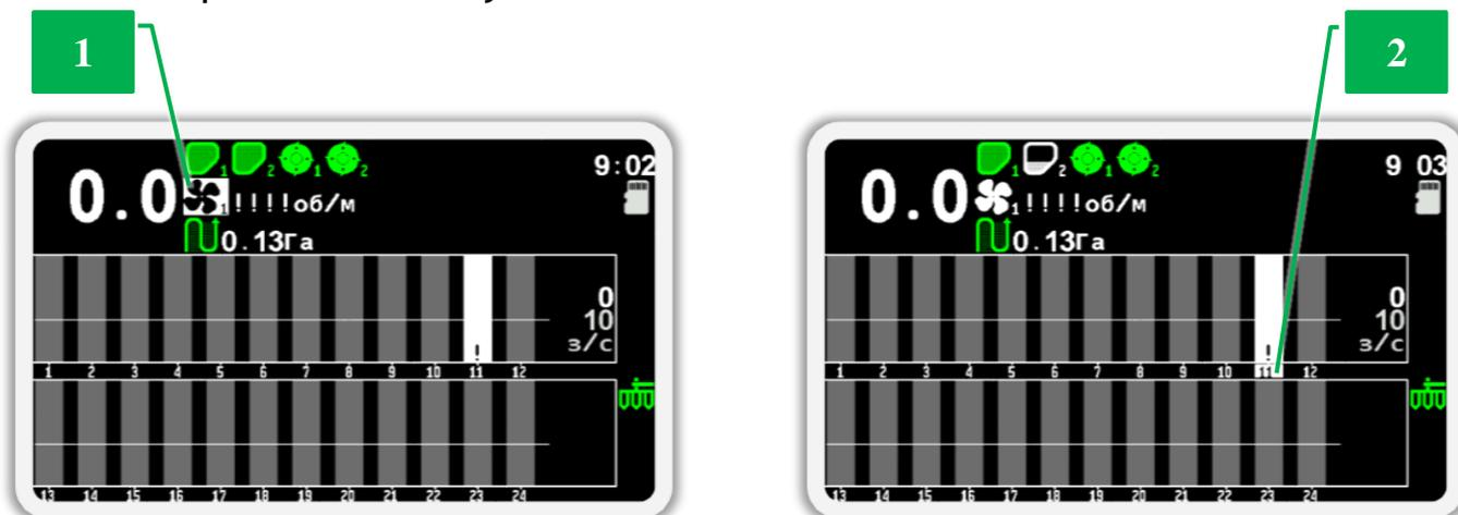
*Рисунок 22 Пример выбранных датчиков: 1 - выбран датчик контроля вентилятора, 2 - выбран датчик высева №11 (белый фон у номера датчика)*
