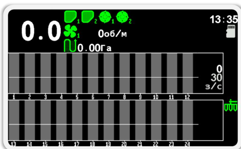
**Рисунок 25** Пример отображения «Главного экрана» тогда, когда установлена связь со всеми датчиками и при этом все датчики поставлены на контроль.
