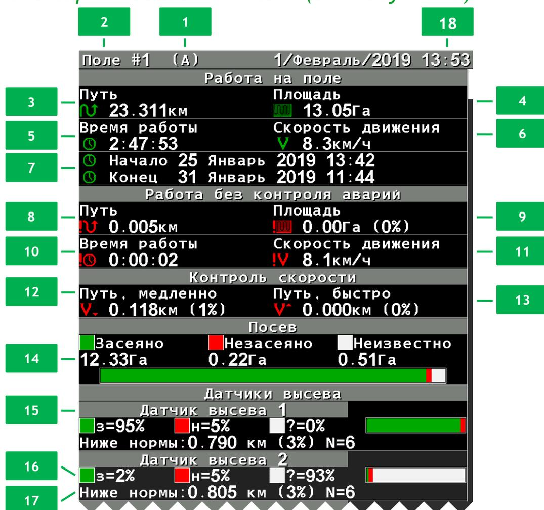
*Рисунок 15 Экран статистики при режиме контроля высева "Поток"*
