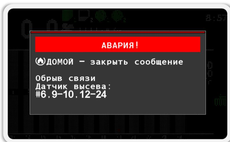
*Рисунок 19 Окно аварийного сообщения «Обрыв связи» с датчиками высева. Номера датчиков высева, с которыми нет связи: 6,9-10,12-24*
