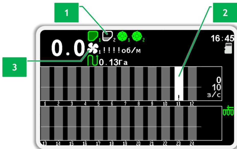
**Рисунок 20** Пример отображения снятых с контроля датчиков. Сняты с контроля следующие датчики: 1 - датчик контроля наполненности бункера, 2 - датчик контроля высева №11, 3 - датчик контроля скорости вращения вентилятора.
