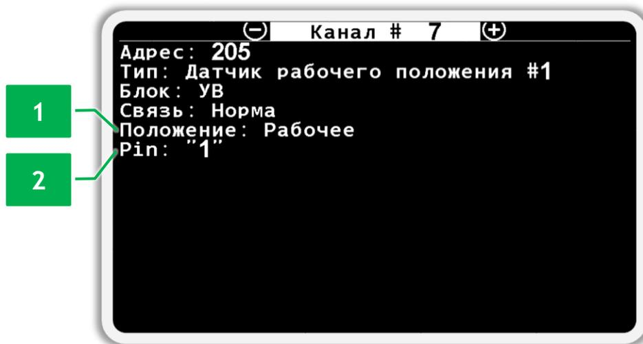
*Рисунок 47 Экран просмотра состояния датчика рабочего положения*
