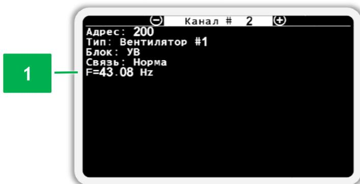
*Рисунок 39 Экран просмотра состояния датчика вращения вентилятора*
