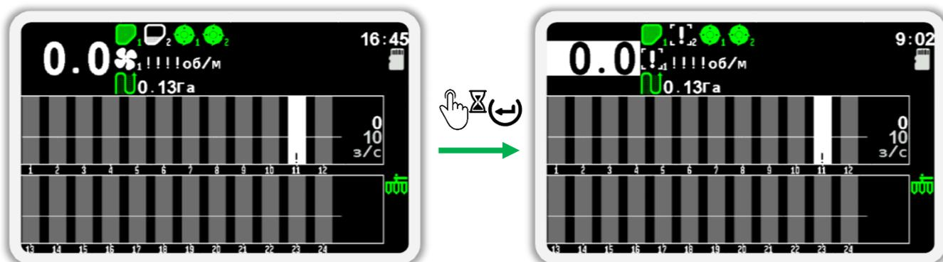
**Рисунок 21** Переход в режим настройки датчиков. На рисунке справа изображен выбранный датчик скорости (его фон окрашен белым цветом).
