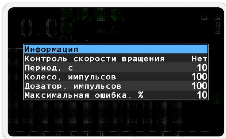
Рисунок 35 Параметры датчика вращения вала дозатора
